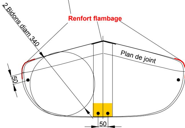
**Faitière centrale** en mousse américaine semi-élastique faisant: Siège (avec récup chutes) et réserve flottabilité
