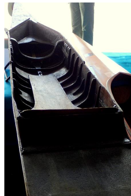
Péroisire de course vers 1870. On voit l'hi-loire raboté pour ménager de la place aux hanches du pagayeur. Vaires-sur-Marne. © Patrice de Ravel - 2019
